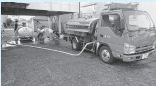
静岡市が設置した容量1,000ℓの給水タンクへ補水をしている様子（谷津町地区）
