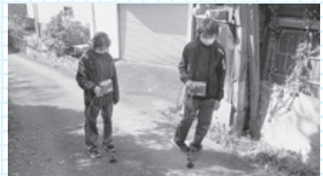
△配水課では、水道管の漏水調査をするために漏水探知機を使って漏水音の調査を体験
