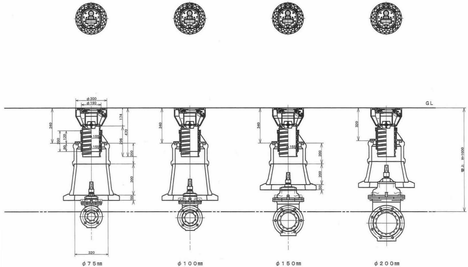
佐久水道企業団型仕切弁筐設置図 (管上1000)
