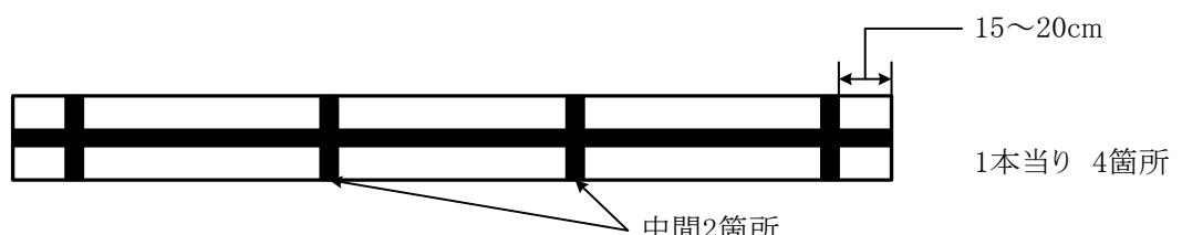
(ウ) 切管、異形管等で(ア)、(イ)に該当しないものは、胴巻きテープの間隔が2m以下になるように巻き付けなければならない。
